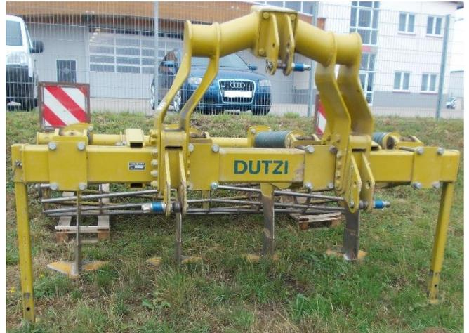
Optimal ist eine Arbeitsgeschwindigkeit von 4-6 km/h. Eine Arbeitstiefe bis 50 cm ist möglich, heißt aber auch ein Leistungsbedarf von über 200 PS. Der Dutzi-Tiefenlockerer wird mit 19,-€/Std. zzgl. MwSt. verrechnet und ist bei uns in der Geschäftsstelle Münster stationiert.
